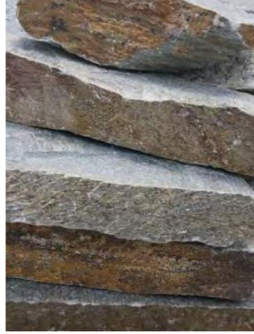
Material für die Mauer, die entlang der Strasse verläuft und durch die die Bewohner die Garage betreten ist Luserna Gneis Giallo. Dieser grau-grünliche Gneis mit hohem Gelbanteil stammt aus der norditalienischen Bergregion Piemont. Beständig und widerstandsfähig, ist er eine exzellente Wahl für die Gestaltung naturnah und zeitlos wirkender Flächen.
